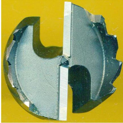
Auch der Bormax<sup>3</sup> by FAMAG hartmetallbestückte Forstnerbohrer verfügt über einen zylindrischen Schaft und paßt in jedes herkömmliche 10 mm-Bohrfutter, bei den kleinen Durchmessern bis 20 mm reicht ein 8 mm-Bohrfutter. Der Bormax<sup>3</sup> eignet sich aufgrund seiner hitzefesten Hartmetall-Bestückung für noch deutlich höhere Drehzahlen als der Bormax aus legiertem Werkzeugstahl, hier die Richtwerte für europäisches Hartholz:
