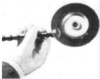
Selbst Sägeblätter mit Hartmetall-Zähnen können Sie so schleifen. Sie benötigen dazu den rictools Universal-Kombi-Halter S mit Kugelgelenk, um die Diamant-Sichtschleifscheibe präzise in den korrekten Winkel einzustellen. Bauen Sie einen kleinen, mindestens 6 cm hohen Auflage-tisch, z. B. indem Sie ein Stück Spanplatte auf einem Holzklötzchen befestigen.
