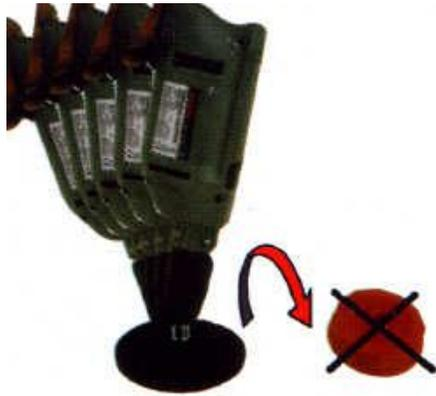
**WICHTIG!** Wenn Sie mit dem Flexo-Fix Flächen schleifen, halten Sie die Bohrmaschine in etwa senkrechter Position! Zu starkes Abneigen der Bohrmaschine hat zur Folge, daß die Gummilagerung des Aufnahmeschaftes überlastet wird, es kann dabei auch zu einer starken Erwärmung kommen. Außerdem erhalten Sie dann Riefen und Kratzer auf Ihrem Werkstück. Wenn Sie Kanten oder ähnliches schleifen wollen, arretieren Sie den Schleifteller mit der Kunststoffhaube!
